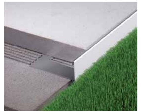
**Bordertec BSR** è indicato nella finitura e protezione di marciapiedi e ballatoi in marmo e pietra o come delimitazione a sgocciolatoio di balconi e terrazze. La particolare sezione ottimizzata del profilo reversibile permette di utilizzare due differenti spessori di pavimentazione con lo stesso profilo. Bordertec BSR è dotato dei necessari pezzi speciali per una posa a regola d'arte (un angolo funge anche da due giunzioni).
