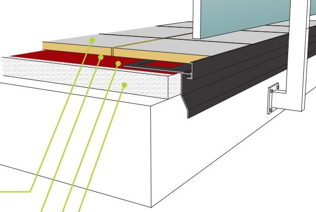
**Bordertec BBO-BCO** profilo perimetrale di finitura e protezione del bordo in cemento esposto di balconi e terrazze, con dentino superiore di finitura e contenimento del rivestimento piastrellato. La sezione ottimizzata del profilo definisce un'ulteriore canalina forata di drenaggio sul bordo del profilo per facilitare lo scarico dell'acqua e dell'umidità residua.
